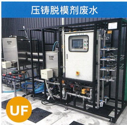
压铸脱模剂废水 新工厂的节能化 (仅需提供凝缩循环泵的处理能源)
