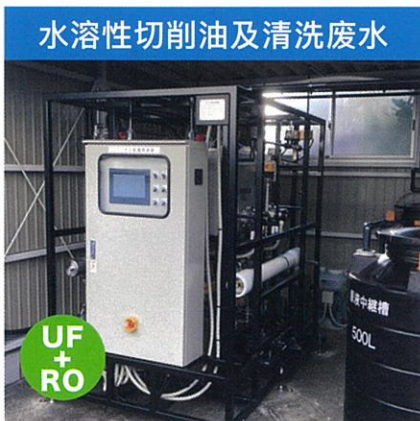
水溶性切削油及清洗废水 通过减少产业废弃物, 削减处理费用 (从产业废弃物的全量处分减量到1/5的浓缩液处分) ※专门用于净化水质的UF+RO混合装置
