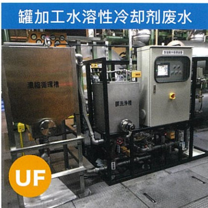
罐加工水溶性冷却剂废水 降低综合排水处理设备的负荷 (通过预处理, 去除冷却剂成分)
